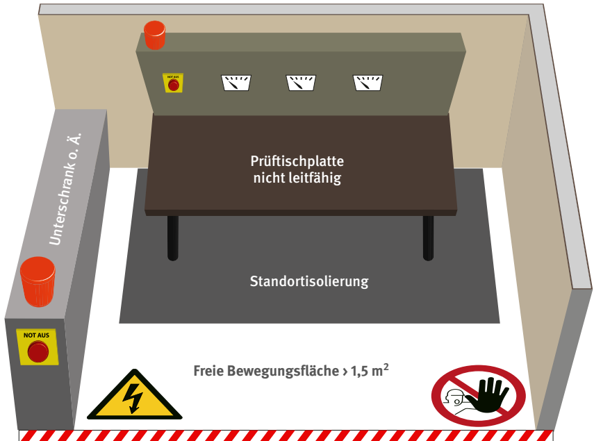
Abb. 6.1 Beispiel für einen Prüfplatz in einer Elektrowerkstatt.
