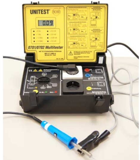
Abb. 5.3 Standard Prüfgerät für die Geräteprüfung VDE 0701-0702; Schutzleiterprüfstrom 10 A
