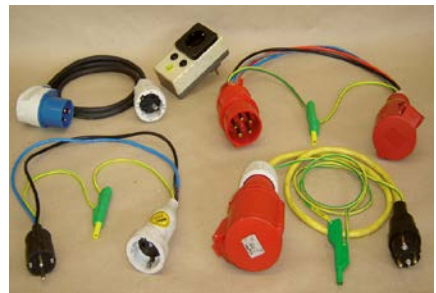
Abb. 7.2 Verschiedene Prüfadapter, u. a. zum Anschluss von Drehstrom-Prüflinge und zur Schutzleiter- und Berührungsstrommessung.
