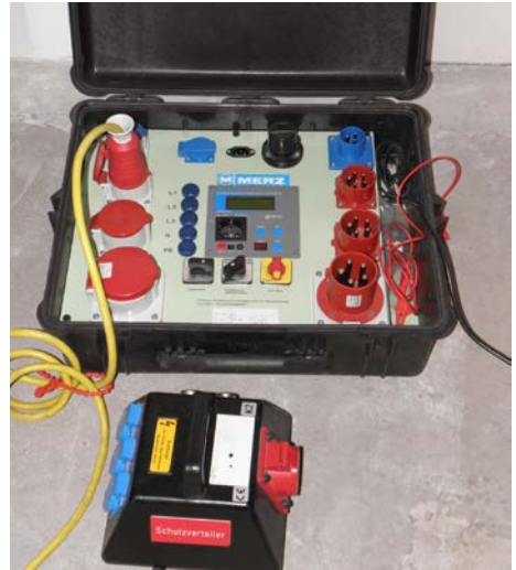
Abb. 5.7 Mobiles Prüfgerät für Verlängerungsleitungen und elektrische Betriebsmittel mit automatischen Gerätetestern zur Prüfung nach VDE 0701-0702 und BGV/GUV-V A3.
